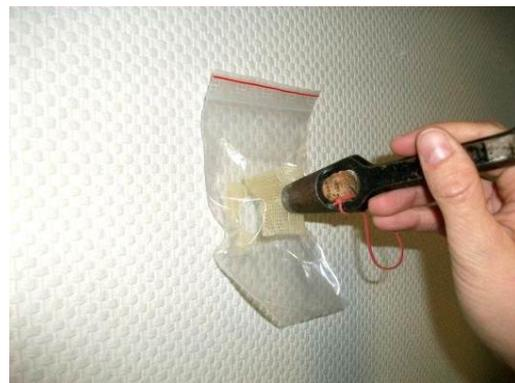
Abb. 6: Stanzeisen auf das doppelseitige Klebeband setzen
